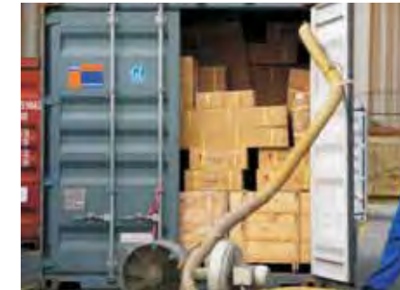
Vorbereitung einer technischen Belüftung
